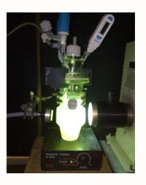
$$TiO_2 + hv \rightarrow h^+ + e^ h^+ + H_2O_{ads} \rightarrow OH + H^+$$
